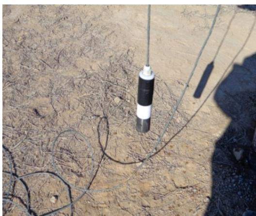
Рисунок 2.3 – Датчик уровня для закачной скважины
