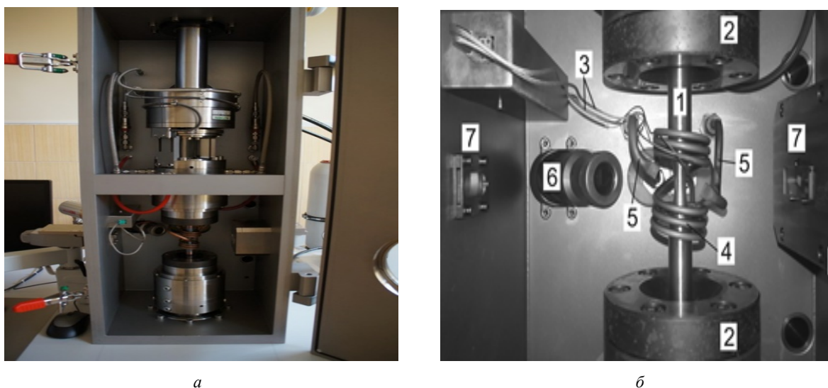
Рисунок 1 – Торсионный пластометр STD 812 (а) и расположение образца в камере (б): 1 – образец, 2 – держатели, 3 – термопара типа К, 4 – электромагнитный индукционный нагреватель, 5 – система охлаждения форсунки, 6 – пирометр, 7 – лазерные датчики для измерения диаметра образца
