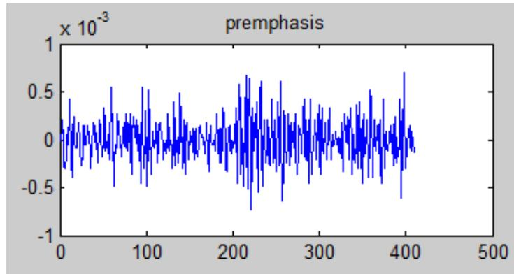
Рисунок 4 – Сигнал, обработанный фильтром первого порядка
