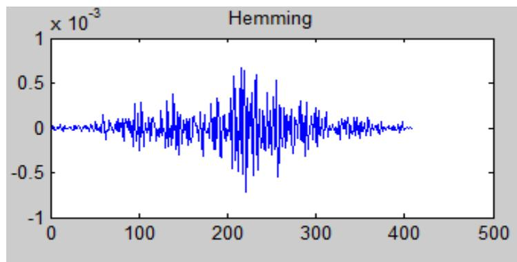
Рисунок 5 – Сигнал, после применения окна Хэмминга
