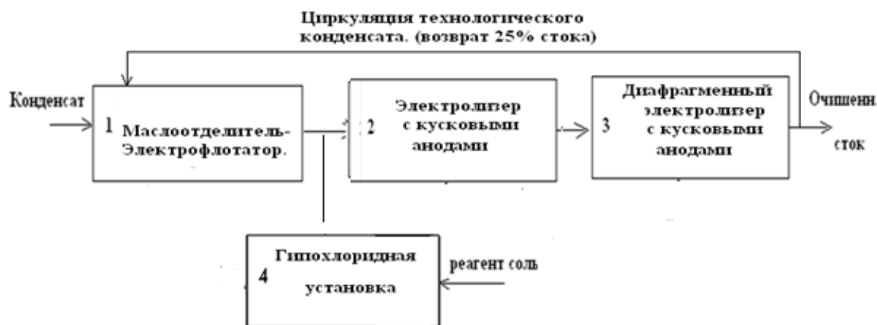
Рисунок 1 – Усовершенствованная принципиальная технологическая схема проведенного пилотного испытания
