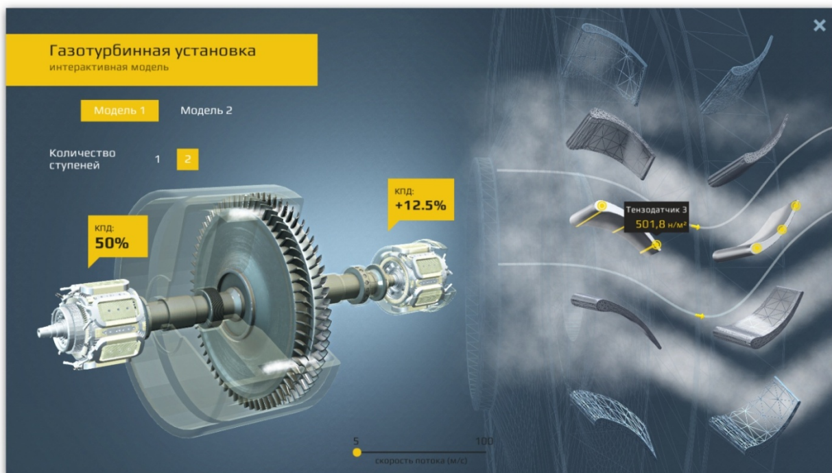
Рисунок 2 – Конструкция 2-х ступенчатой газотурбинной установки, КПД от двух ступеней - 62,5%, на участках лопастей показаны измеренное давление динамического напора потока газа
