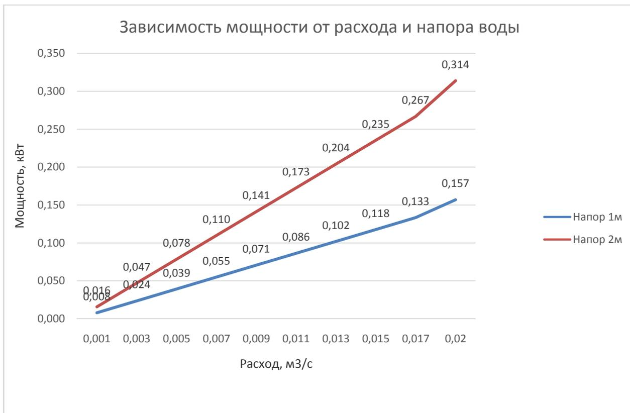
Рисунок 3 – График зависимости мощности от расхода и напора воды (при Н = 1, 2 м)
